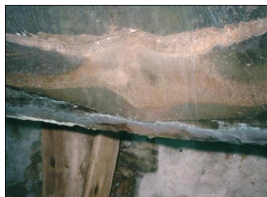
Usure de la cloche aux points de frappe. Photo extraite du dossier Mairie, 2000.
